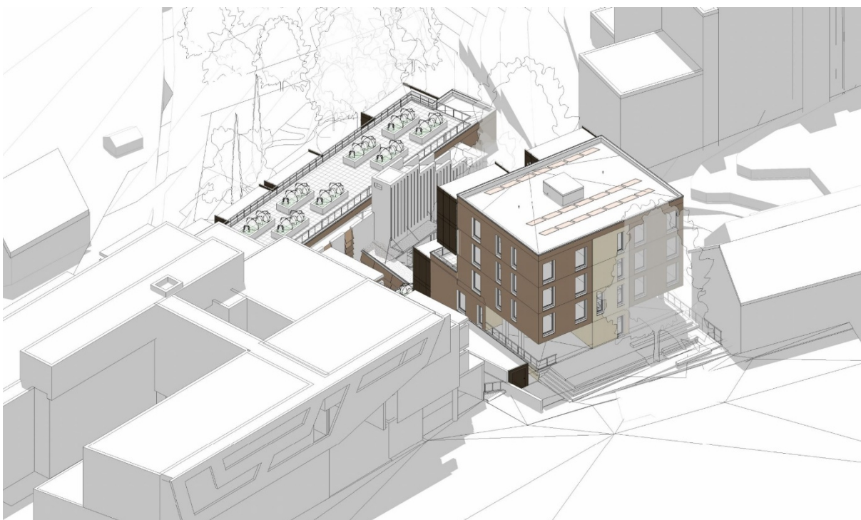
Blick von Nordosten auf den Entwurf mit der deutlich sichtbaren „Stufung“ und Gliederung der Gebäudeteile, dem Vorplatz mit Rampen und Stufen und Bepflanzung, sowie das „Abrücken“ von den Nachbargebäuden, wodurch sich Durchblicke Richtung Süden öffnen. Bewusst ist die „Anbaupflicht“ im Bereich des Vorplatzes der Obergeschosse definiert, um eine geordnete Städtebauliche Gebäudeanordnung sicher zu stellen und im Straßenverlauf dem Neubau einen Vorplatz und Sockel vorzusetzen.
